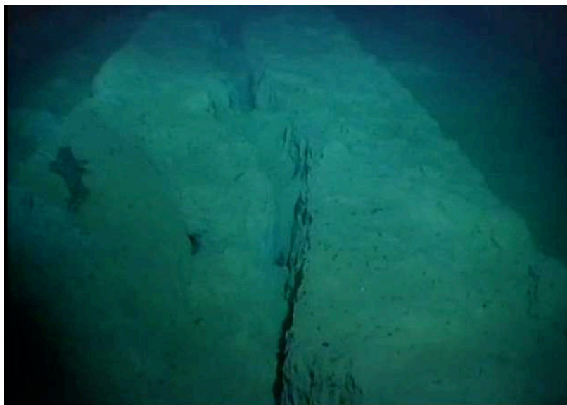
Figura 28: Ejemplo de una sección de cable arado en 773 m WD un año después de la instalación
