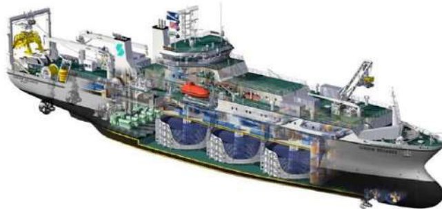
Figura 26: Embarcación instaladora de tipo Reliance Class de SubCom (Fuente: SubCom)
