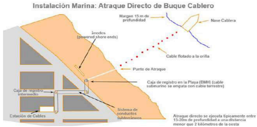
Figura 34: Esquema del proceso de aterrizaje del cable a la playa (Fuente: SubCom).
