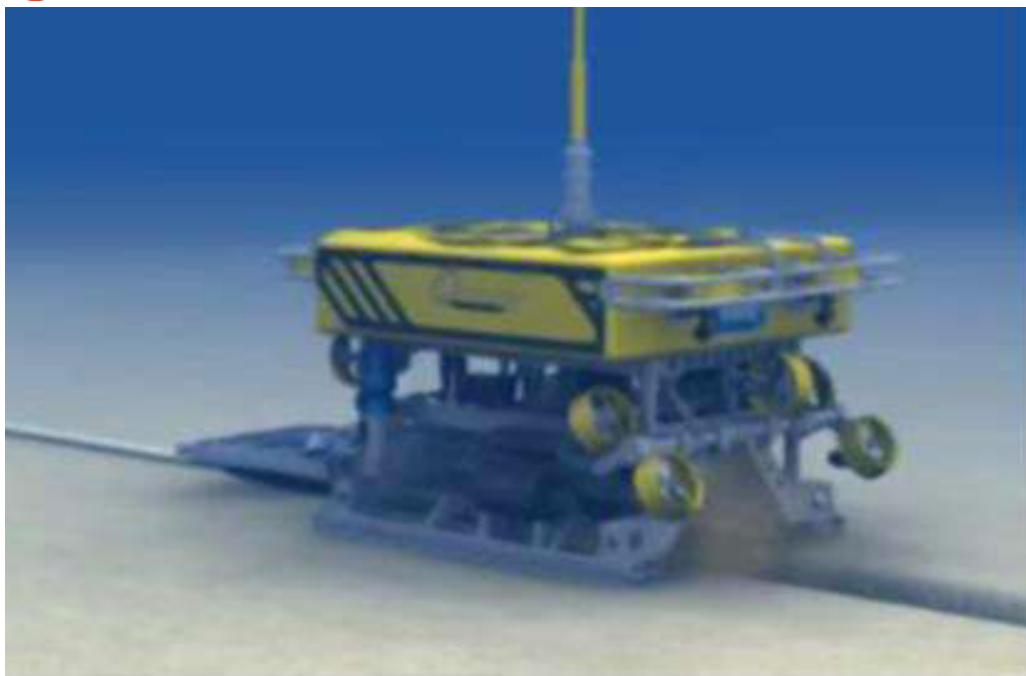
Figura 31: Esquema de operaciones PLB por ROV
