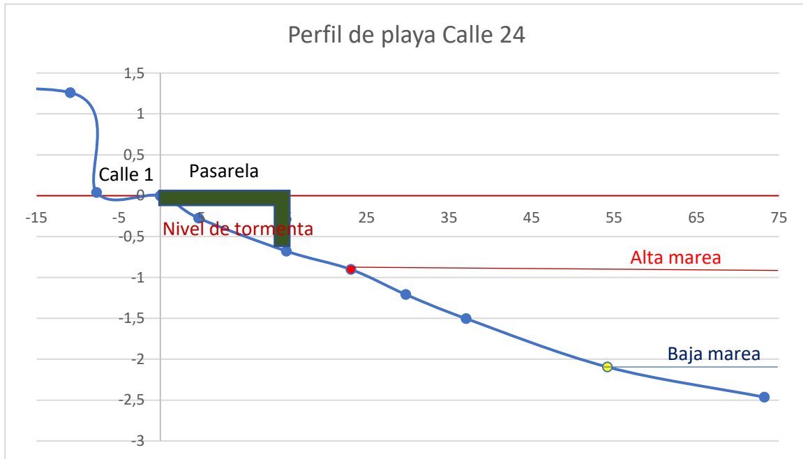
Figura 86: Perfil de playa de la calle 24 en Las Toninas. Fuente propia
