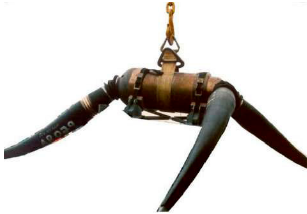
Figura 32: Branching Unit (BU)
